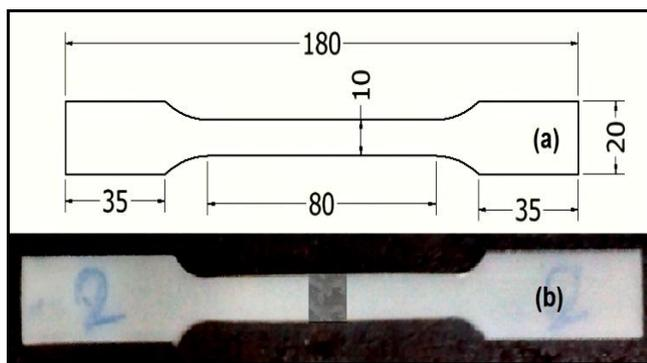
**Fig. 5: Tensile specimen**
