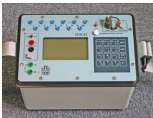
Fig 2: Résistivimètre
